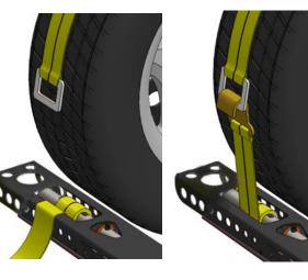
6. À l'aide d'un cliquet à entraînement de 1,27 cm, serrer le treuil et tourner dans le sens contraire des aiguilles d'une montre.
