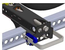
5. Faire passer la courroie longue munie d'une boucle autour du pneu et la rattacher à l'extrémité de la courroie courte. Positionner les taquets à crête dans la bande de roulement. Rattacher les pointes en position opposée au pneu comme indiqué.
