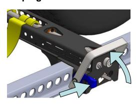
Envelopper la courroie autour du corps de cale. Répéter la procédure de déchargement pour toutes les cales et les remettre dans les bacs de stockage. S'assurer que les courroies sont bien rangées dans les bacs.
